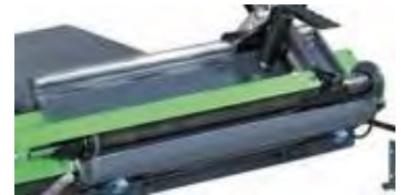
Eř zamanlı çift harekete olanak sađlayan tařıma platformu
